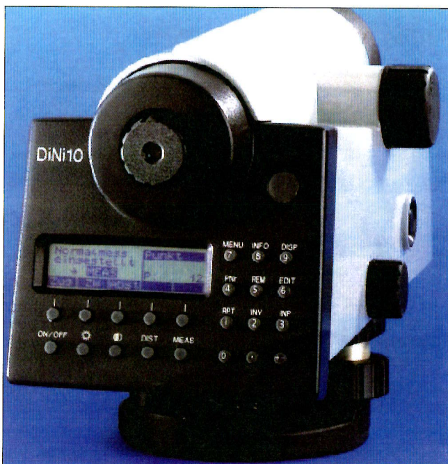
Figure 237. Le Dini10n est motorisé pour les auscultations en continu © Zeiss
